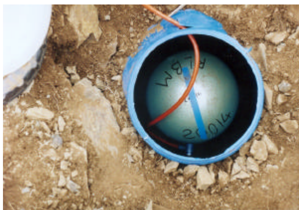
Figure 2. Les 2 éléments d'une station type en Mongolie : l'enregistreur sous une yourte, le capteur (ici, STS2) enterré dans un bidon de plastique.
