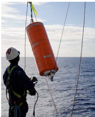
Mise à l'eau d'un hydrophone (l'hydrophone est situé dans la bouée, le capteur est fixé sur la cage métallique inférieure), électronique d'acquisition, et exemple de données acquises avec nos instruments (signal et spectrogramme entre 0 et 40 Hz).
